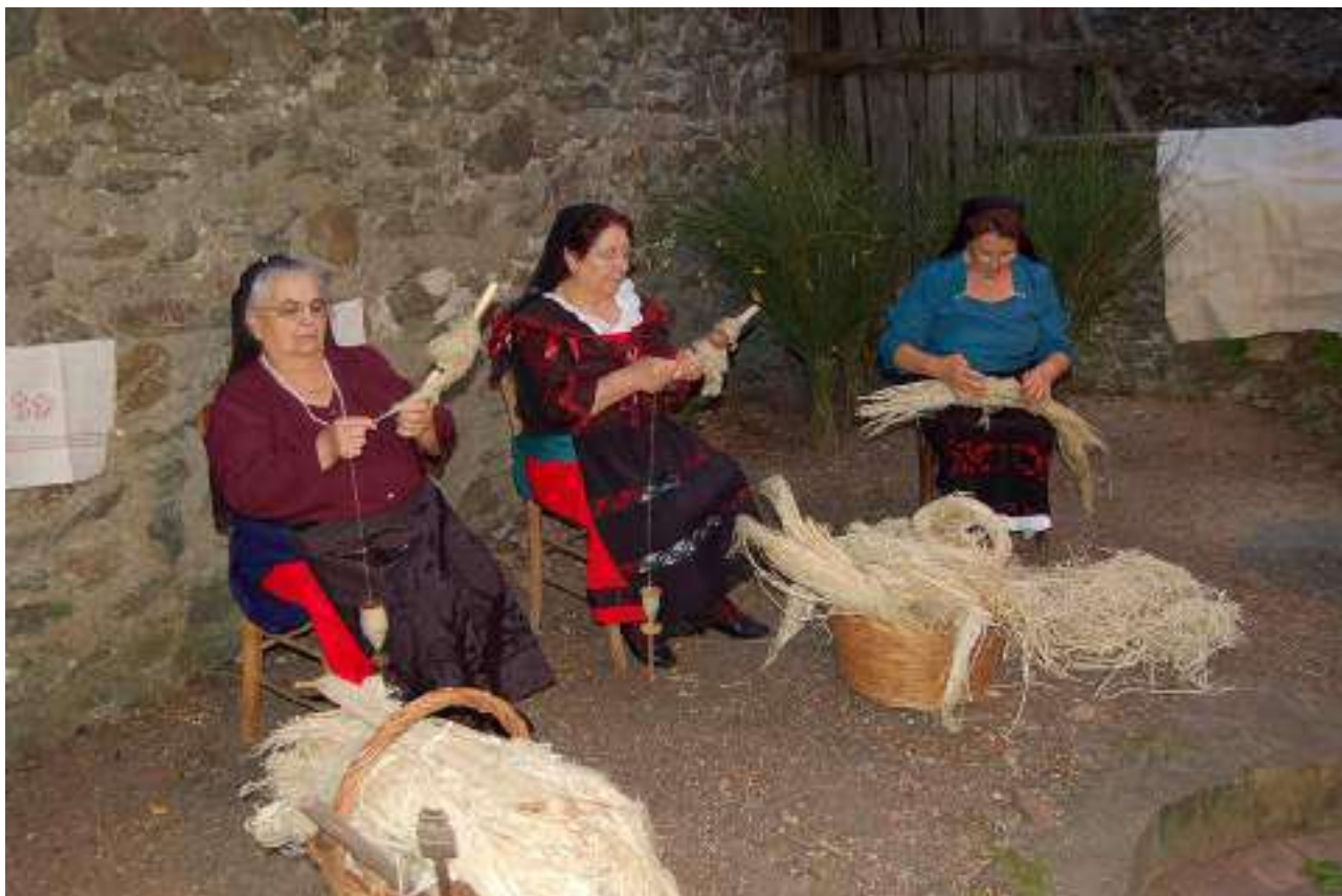
Immagine n. 20 pulitura della massa fibrosa e filatura manuale con il fuso (Fonte archivio fotografico Pro Loco Serrastretta—CZ)
