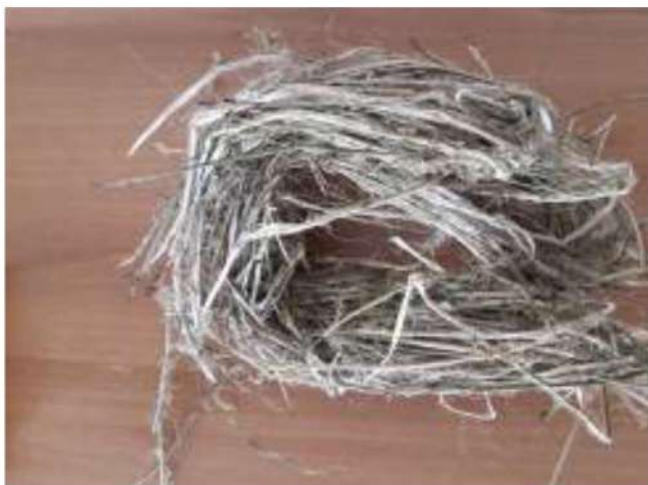
Immagine n. 31—Vermene dopo il processo estrattivo e dopo l'asciugatura al sole per lo sbiancamento
