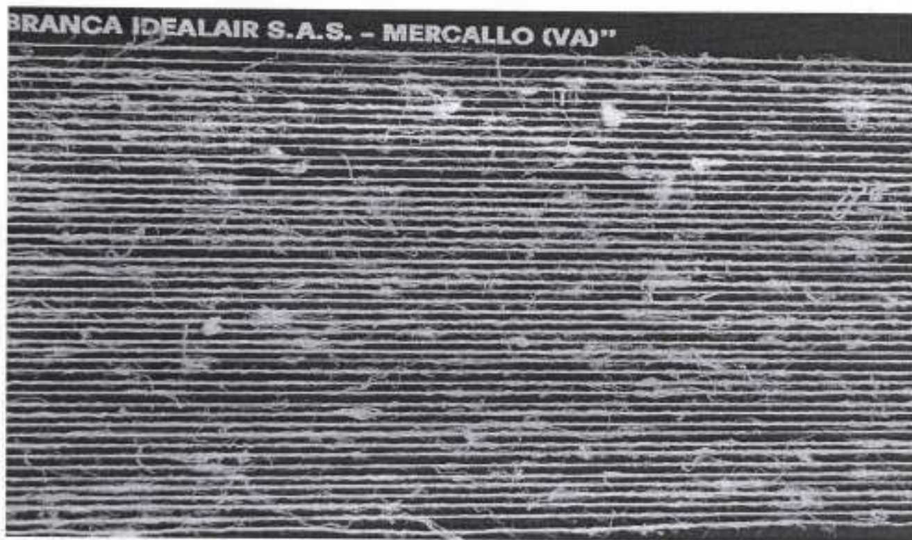
Filato di ginestra realizzato manualmente avvolto su tavola nera per l'esame dell'andamento della struttura
