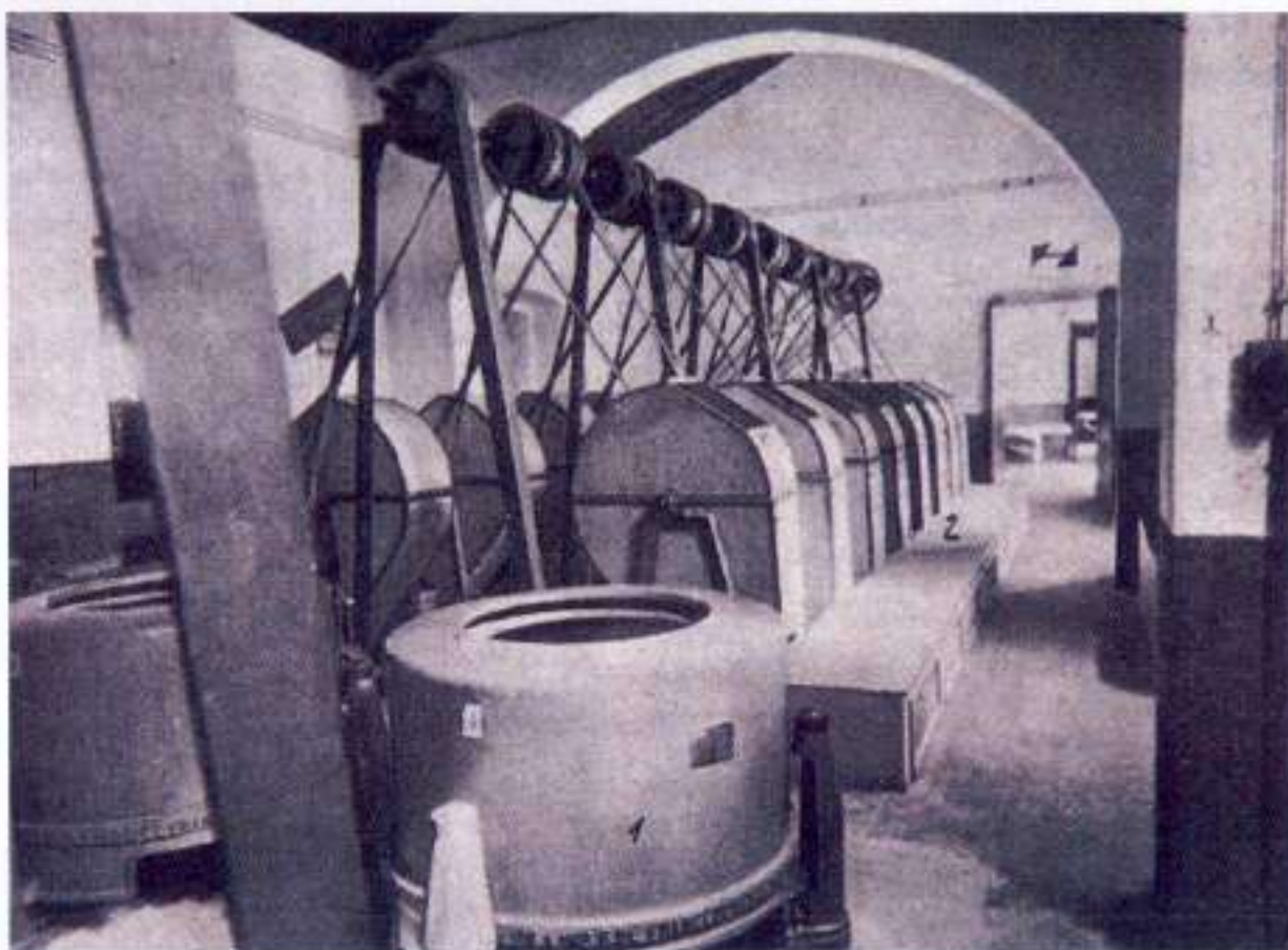
Sfibratura meccanica della ginestra - anni quaranta (da A. BOGGIA, Come si utilizza la ginestra)
