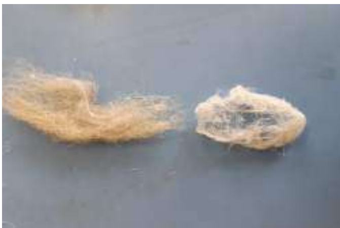
Immagine n. 47—Confronto tra la fibra grezza e il campione di fibra che ha subito il trattamento di sbiancamento con ipoclorito di sodio—Metodo estrattivo n. 1
