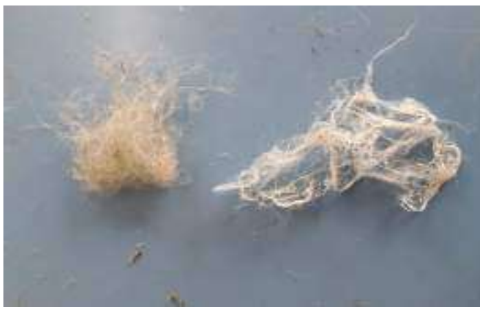
Immagine n. 48 -Confronto tra la fibra grezza e il campione di fibra che ha subito il trattamento di sbiancamento con ipoclorito di sodio—Metodo estrattivo n. 2
