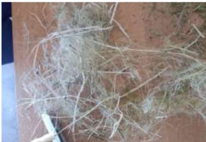
Immagine n. 31—Vermene dopo il processo estrattivo e dopo l'asciugatura al sole per lo sbiancamento
