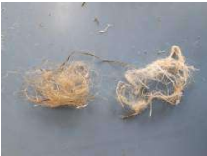
Immagine n. 49—Confronto tra la fibra grezza e il campione di fibra che ha subito il trattamento di sbiancamento con ipoclorito di sodio—Metodo estrattivo n.3
