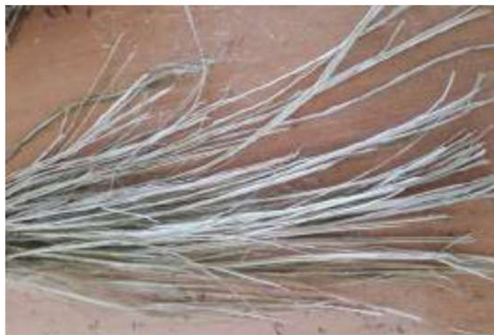
Immagine n. 32— Vermene pettinate la separazione della fibra dai ginestruli
