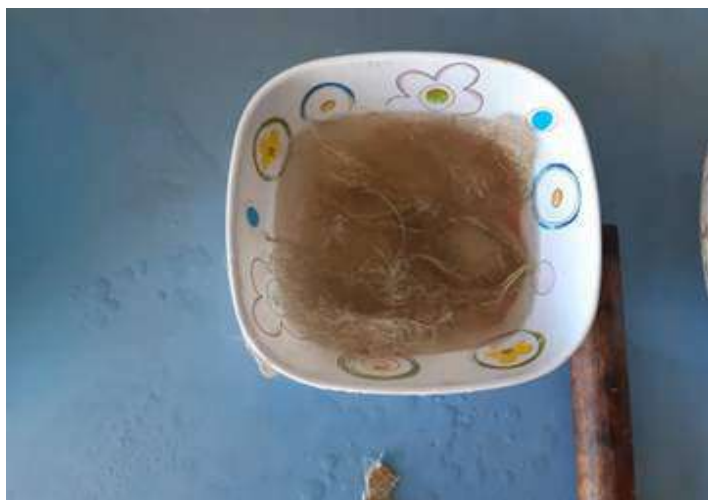
Immagine n. 50—Trattamento di ammorbidimento, solo acqua, ammollo durato 2 gg.
