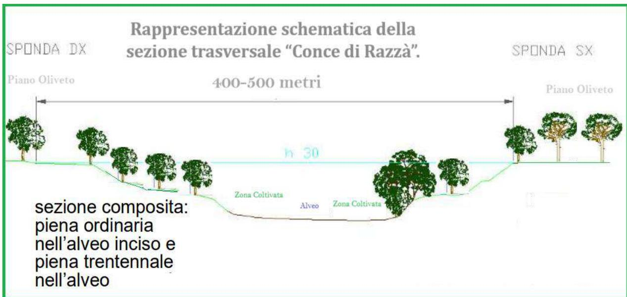
Fig. 04 Sezione trasversale "Conca di Razzà". Rielaborato e adattato da Pietro Humberto Spirli - ARSAC CSD Gioia Tauro. Disegno originale di Preti F., (2014) "Sicurezza idraulica e vegetazione ripariale".
