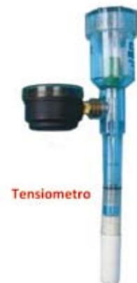
Quando il suolo si bagna di nuovo l'acqua viene richiamata all'interno, durante questo processo piccole quantità di aria entrano nel tensiometro sostituendosi all'acqua ed è quindi necessaria la manutenzione di riempimento con nuova acqua.
